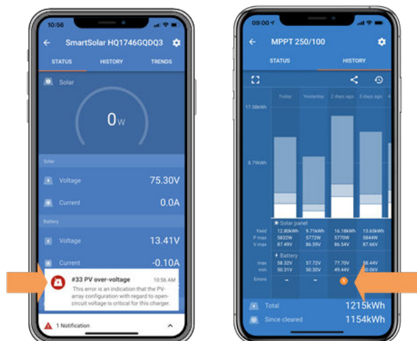
VictronConnect : capture d'écran d'une erreur #33, et capture d'écran de l'historique indiquant une erreur.
